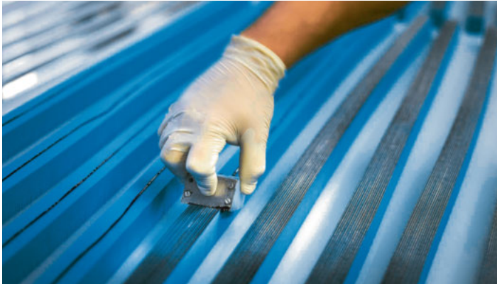
Auf die Polyurethan-Blöcke wird eine Aluminiumplatte geklebt. Die Klebeverbindung ist genauso sicherheitsrelevant wie das Elastomer selber.
