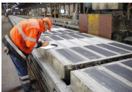
Schwellensohlen ECOVIB® USP: die speziell kraftschlüssige Methode.
