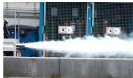
Expulsion haute pression de l'azote liquide et de l'eau.
