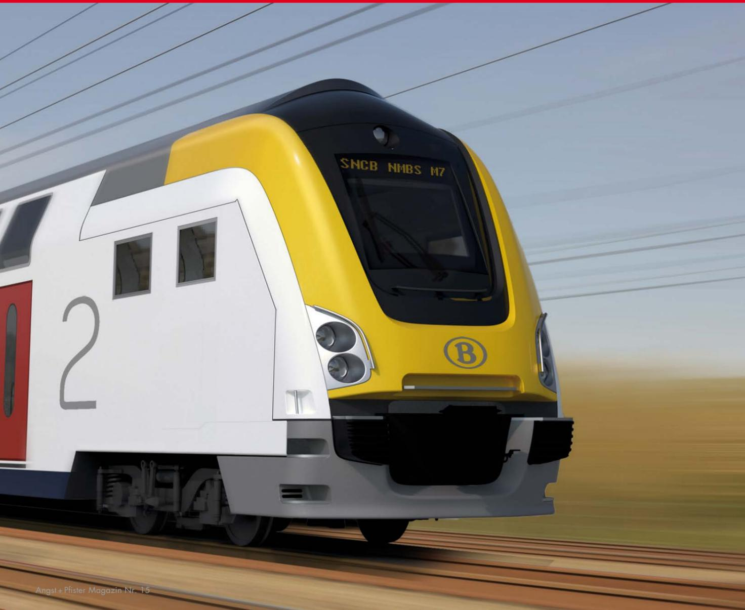
Das M7-Bahnprojekt – eine moderne Mobilitätslösung mit höchstem Standard für die Menschen in Belgien: Fast 1'400 neue Doppelstockwagen sollen ab 2018 auf dem belgischen Eisenbahnnetz ins Rollen kommen. Der Angst+Pfister-Kunde Alstom baut für diesen Grossauftrag eine erste Charge von 90 motorisierten Triebfahrzeugen. Dafür benötigt Alstom Antivibrations- und Fluidtechnik-Komponenten für die eingebauten Transformatoren.
