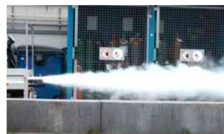
Espulsione ad alta pressione di azoto liquido e acqua.
