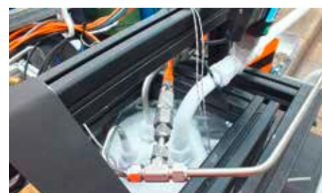
Ghiaccio sul tubo principale verso il motore.
