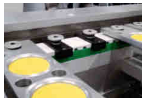
Innesto sulla cinghia dentata dei supporti per capsule.
